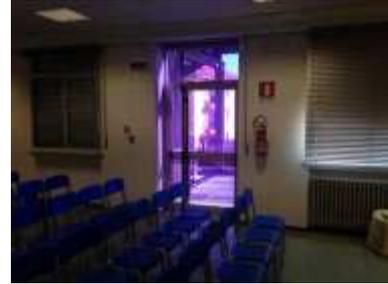
Le vie di fuga e le uscite di emergenza sono segnalate chiaramente con apposita cartellonistica. Hanno una larghezza minima di 120 cm ed una altezza da terra minima di 200 cm.
